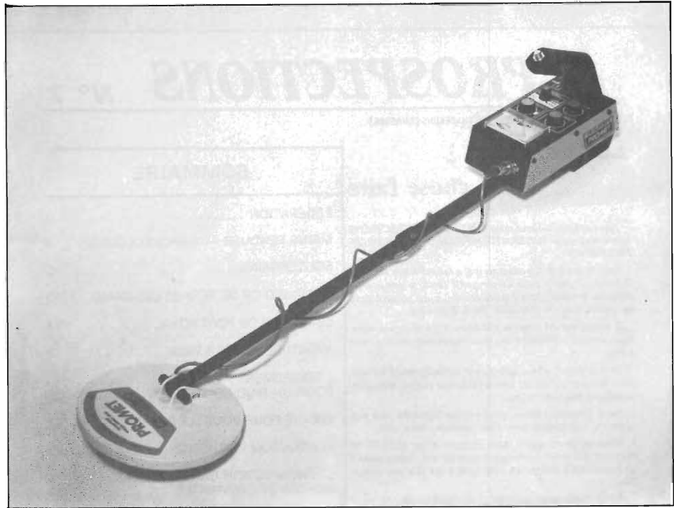
Ecco come si presenta il rivelatore completo di tutte le sue parti. L'unico collegamento da effettuare è quello della testa rivelatrice all'apparecchio vero e proprio.
